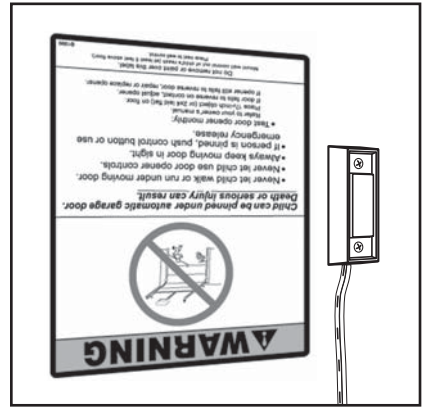
FIG. 3-5 Montaje de la etiqueta de advertencia de atrapamiento. Apposition de l'étiquette d'avertissement de risque de coincage
